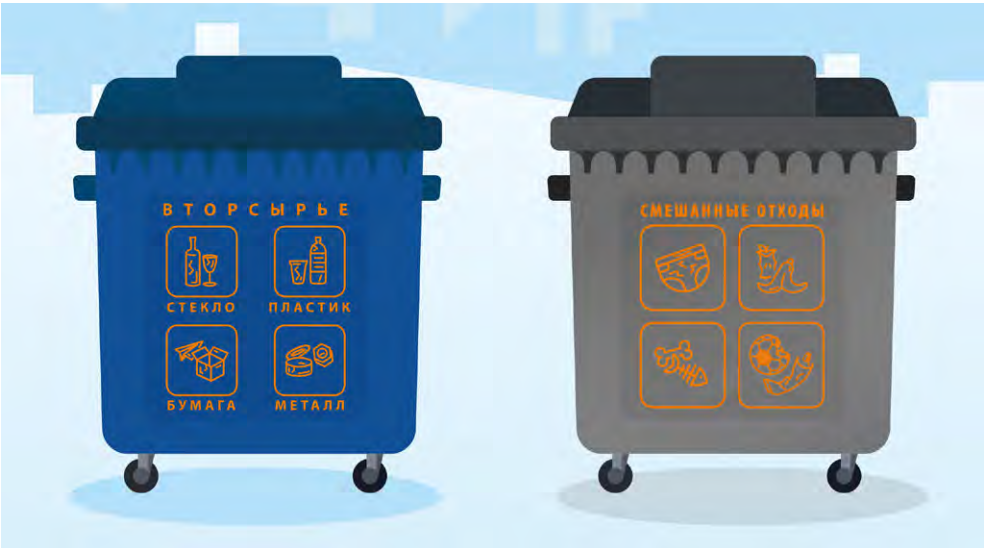
Рисунок 3. Двухконтейнерная система раздельного накопления отходов в городе Москве
