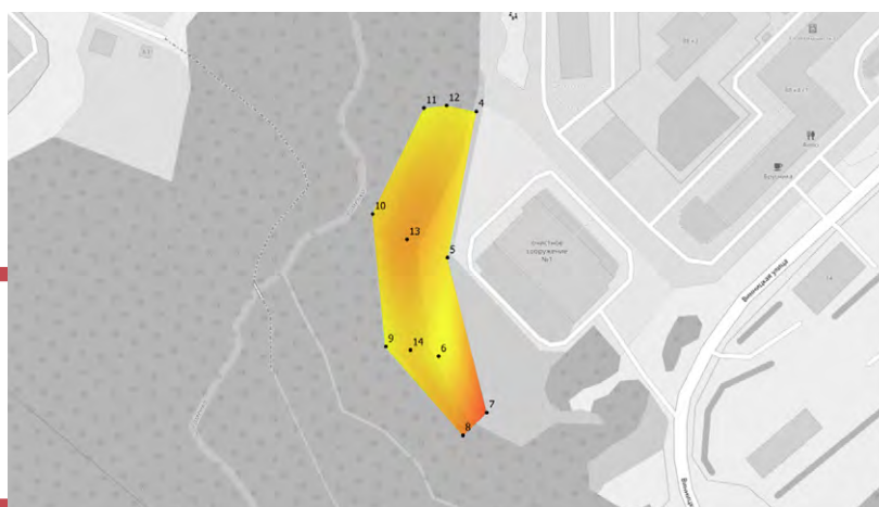
Рисунок 25. Карта вертикальных смещений приповерхностной зоны грунтов на оползневом участке Раменка-5 за период 2019-2020 гг.
